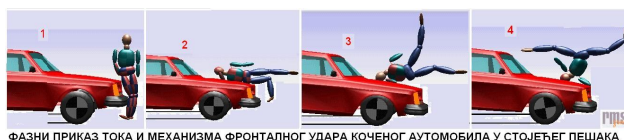
ФАЗНИ ПРИКАЗ ТОКА И МЕХАНИЗМА ФРОНТАЛНОГ УДАРА КОЧЕНОГ АУТОМОБИЛА У СТОЈЕЋЕГ ПЕШАКА
